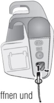
Abdeckung öffnen und Anschlussstück einführen
