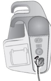
Anschlussstück zum Festziehen drehen
