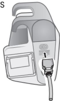
Anschließen der SpO<sub>2</sub>-Sonde
