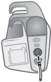
Anschließen eines einlumigen Schlauchs
